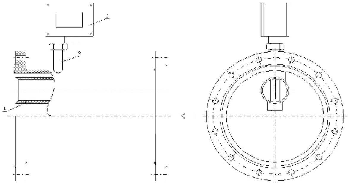
1 – измерительный участок – ВЭП с Ду 50 мм (для ВЭПС с Ду 200 мм) или ВЭП с Ду 80 мм (для ВЭПС с Ду 250, 300 мм); 2 - стойка; 3 – корпус УФС.
