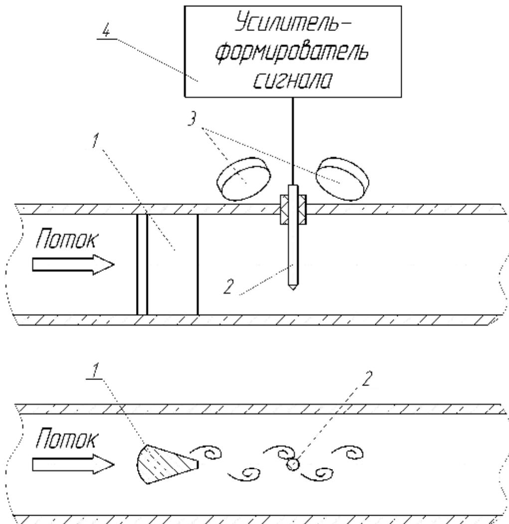
Рисунок 6 – Схема для пояснения принципа действия ВЭС
