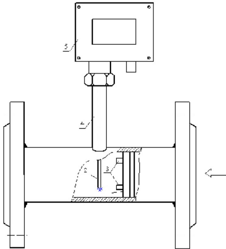
1 – тело обтекания; 2 – сигнальный электрод; 3 – полюса магнитной системы; 4 - стойка; 5 – корпус УФС.
