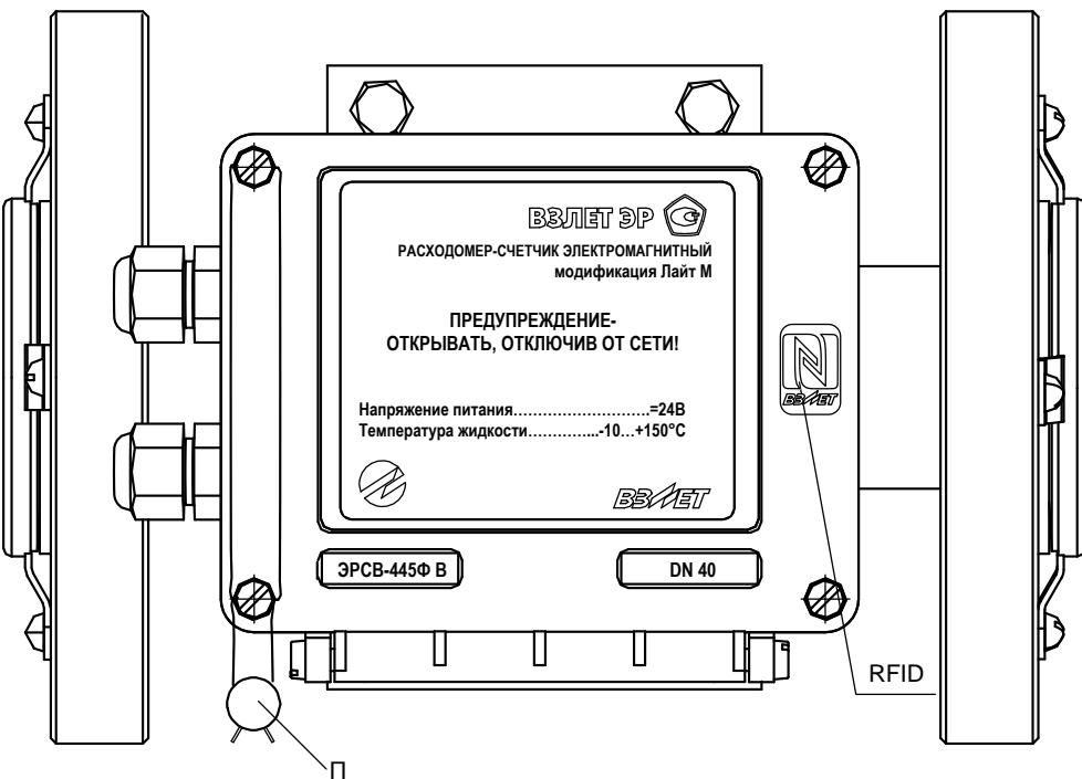
**Рис.Б.8б. Вид сверху измерительного блока расходомера фланцеванного исполнения с металлическим измерительным блоком.**
