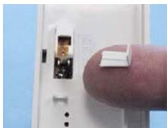
3. Навесить сверху распределитель на тепловой адаптер, нажать на нижнюю часть и защелкнуть пломбу, входящую в комплект поставки.
