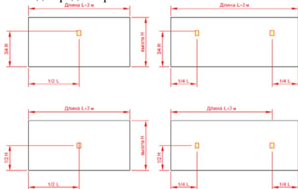
1. Зафиксировать стандартный тепловой адаптер (поставляется в комплекте с распределителем) в выбранном месте с помощью отвертки PH2 и монтажного комплекта.
