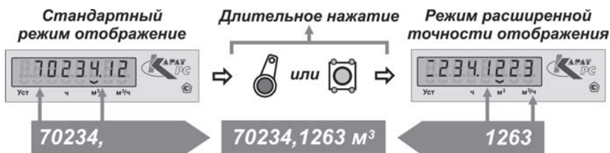
Рисунок 1.14 – Алгоритм просмотра на ЖКИ интегральных значений накопленного объема
