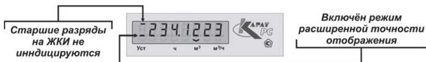
Рисунок 1.13 – Отображение накопленного прямого объема в режиме расширенной точности отображения
