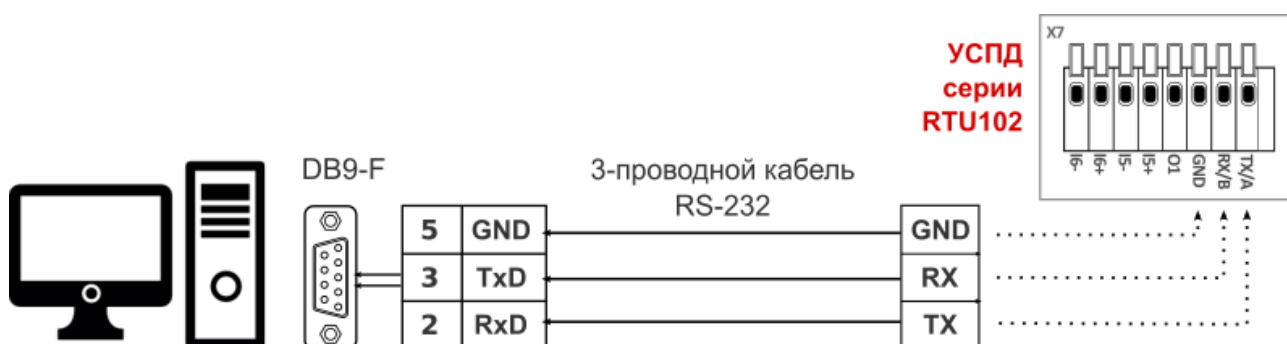
Рис. 36. Подключение УСПД серии RTU102 к ПК по интерфейсу RS-232.
