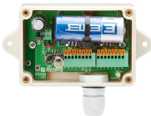
Рис. 1. УСПД TELEOFIS серии RTU102. Внешний вид без крышки.
